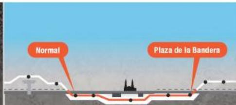
La parte subterránea de la Línea 3 del Tren Ligerero consta de 5.4 kilómetros, pero la tuneladora sólo perforará cuatro kilómetros; en los extremos, en La Normal y Plaza de la Bandera, se utiliza otro proceso constructivo.
