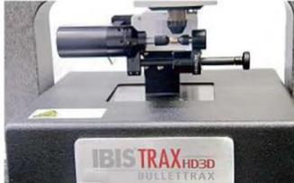
El Sistema IBIS analiza los proyectiles y los compara con los existentes en una base de datos.
