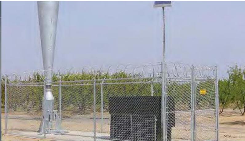
Los cañones antigranizo detonan gas de acetileno para emitir ondas sónicas ionizantes que truncan el proceso de formación de granizo, se usan para proteger a las cosechas susceptibles a daños por ese fenómeno meteorológico.
