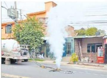
La manguera se rompió por la fricción con una lámina de acero.
