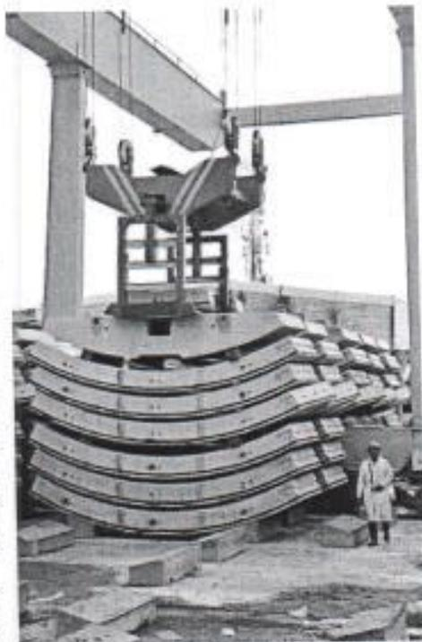
La producción de dovelas necesarias para el túnel, que ensamblarán 2 mil 230 anillos, concluirá en marzo del 2017.
