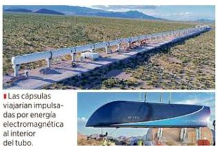
Las cápsulas viajarían impulsadas por energía electromagnética al interior del tubo.
