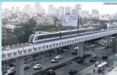
ENSAYO. Desde inicios de este mes, principalmente durante las noches, la Secretaría de Comunicaciones y Transportes (SCT) realiza pruebas dinámicas con hasta con 12 trenes en toda la Línea 3 (L3) del Tren Ligero, con las cuales se ponen en funcionamiento todos los subsistemas necesarios, como energía de tracción, vías, catenaria, señalización, telecomunicaciones, entre otros, confirmó el Sistema de Tren Eléctrico Urbano (SREU). Se detalló que se ha dado capacitación teórico-práctica al personal para operar las unidades.
