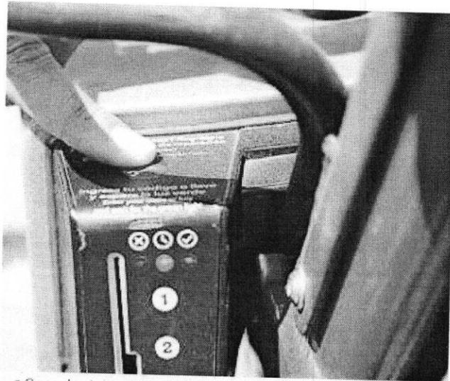
■ Cuando detecte una avería, repórtela en este botón ubicado en el puerto de anclaje; con esto se bloqueará la bici.
