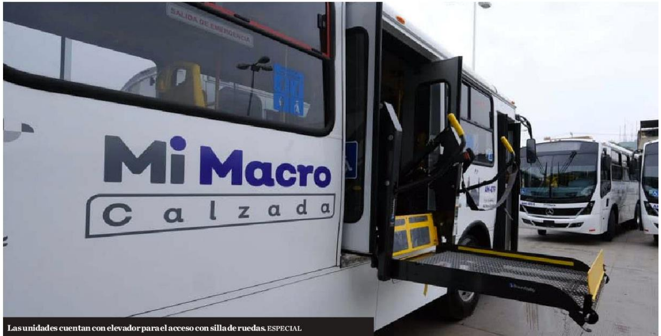
Las unidades cuentan con elevador para el acceso con silla de ruedas. ESPECIAL
