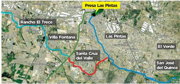
El canal de Las Pintas (verde) corta el tramo del Arroyo Seco (rojo) hacia La Colorada (azul) y desde entonces el escurrimiento pluvial es interceptado y enviado a la presa de Las Pintas
