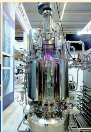
Conacyt exhibe este biorreactor capaz de generar microorganismos para reducir residuos de la industria alimentaria.
