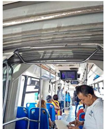
La parte superior de las piezas que unen a los camiones muestran desgaste por el Sol y la lluvia y están rotas.
